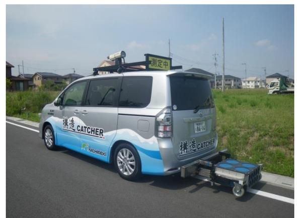
写真- 6 舗装構成測定車
